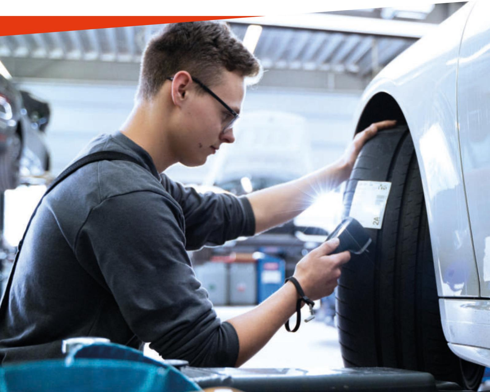
Unsere digitale Lösung für die Erfassung von Reifenprofiltiefen bietet Ihnen 100% Sicherheit durch eine nahtlose Übertragung mittels Bluetooth®. Die digitale Datenerfassung direkt am Rad macht jeden weiteren Dokumentationsaufwand überflüssig. So können Sie Ihre ermittelten Daten sofort und ohne Unterbrechung in Ihr bestehendes ATBAS übertragen und alle damit verbundenen Vorteile nutzen.
